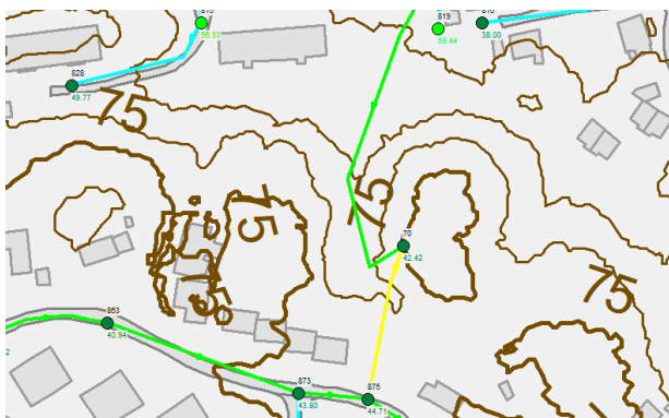
Figur 4 - "Ringledning" med forsyning fra Trondalen VP
