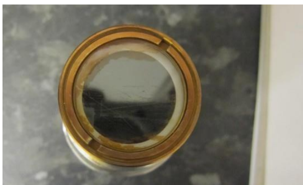
Figur 2 Detalj Ripet og spor av lekkasje på sensorlomme
