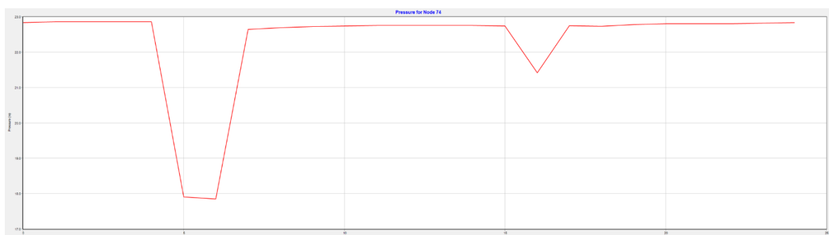
Figur 6 - trykkvariasjon i løpet av 1 døgn. Brannvannsuttak 20 l/s
